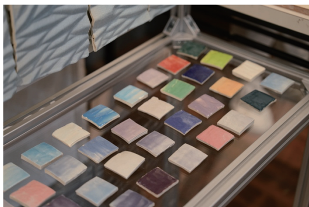
Fig.7 単色顔料を用いた釉薬の物理試験片
