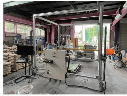
図3 本研究で用いた建設用3Dプリンタ
