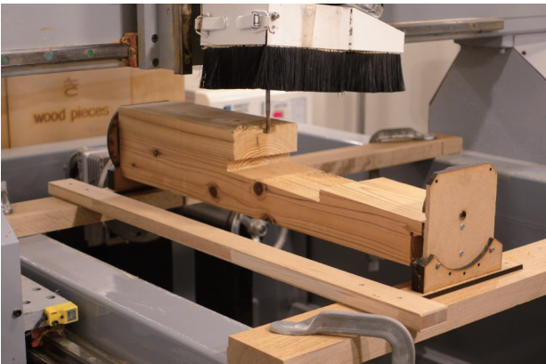
図 5. 治具を利用した継手加工
