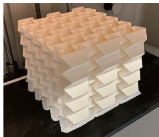
図 1. 3D プリンタによるマルチセル構造の造形
