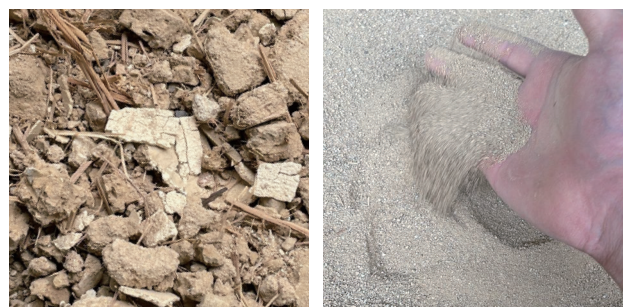
図 1 廃棄土壁とそれを原料とした再生壁土
