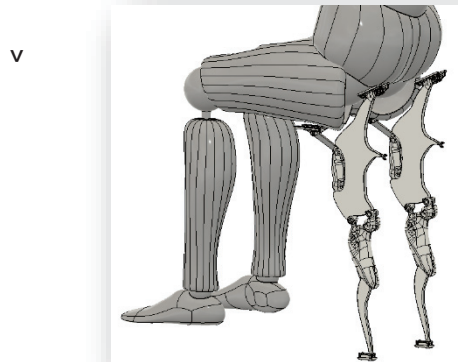
図5 外骨格構造を有する身体支持具
