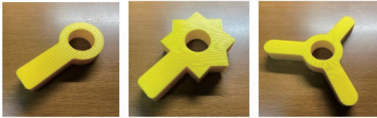
図8 ペットボトルオープナーの設計候補
