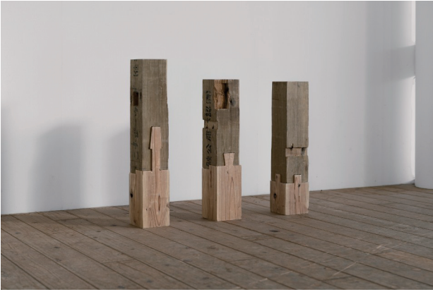
図 2. 鎌継ぎ、蟻継ぎ、目違継ぎ
