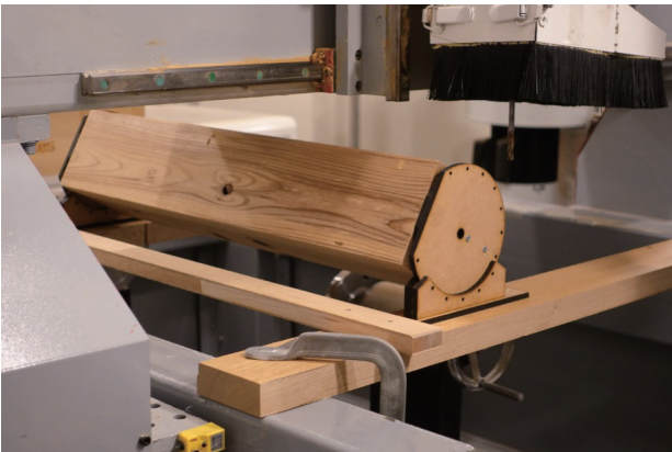
図 4. 加工面を変更可能な治具
