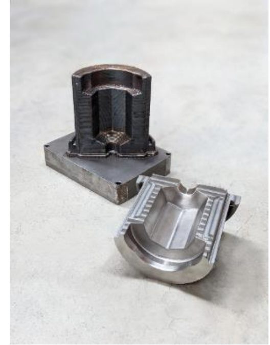
SS316L – Glass Mold Core Meltio M450 Size: 158,5 x 79,3 x 144,3 mm Weight: 6 kg Print Time: 24 h 原材料費: 30,000円
