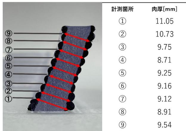
図 4. 造形物断面の肉厚計測
