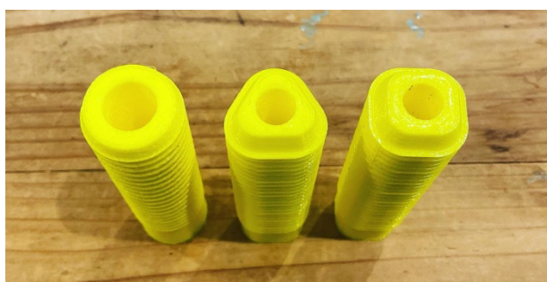
Fig. 7 3種類の異なるパラメータで3D プリントした自助具
