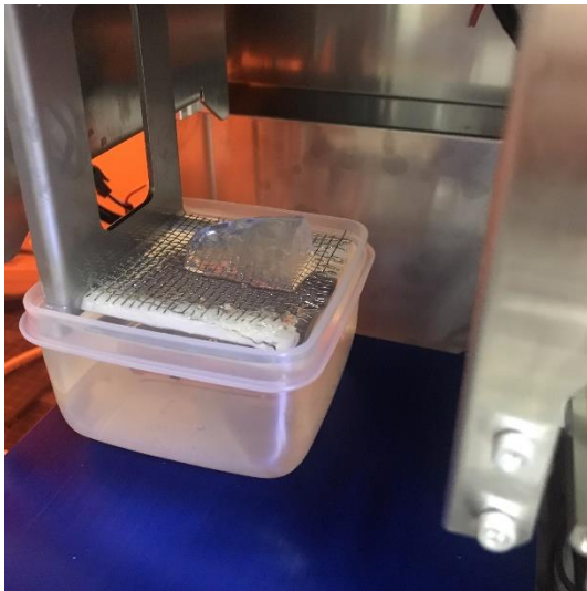
図 2. GelPiPer でゲル構造物を造形している様子
