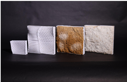
図1.Fungus Bricksの製造過程
