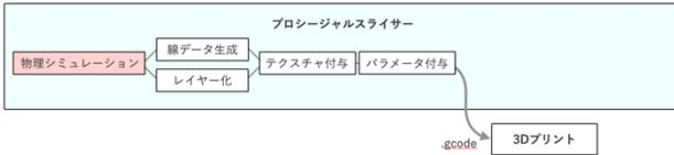
図 5. 物理シミュレーションを利用した 3D プリントフロー
