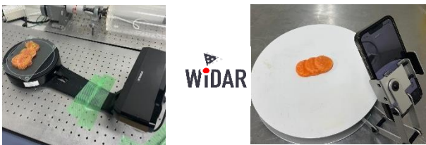
図3 Einscan-SEとスキャンの様子(左)、WIDARとスキャンの様子(右)
