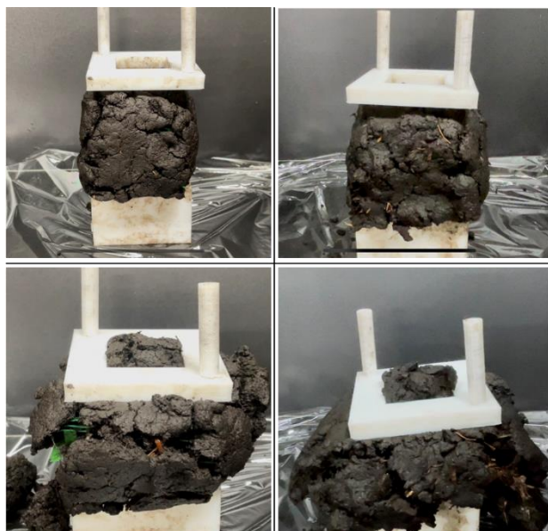
図 4.支持構造の有無による圧縮収穫の比較 (左:支持構造有り 右:支持構造無し)
