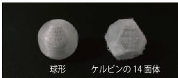
図 2. FFF 3D プリンタで出力可能な構造体 2 種
