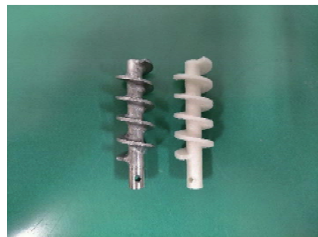
図 5 金属スクリューと 3D プリントスクリュー
