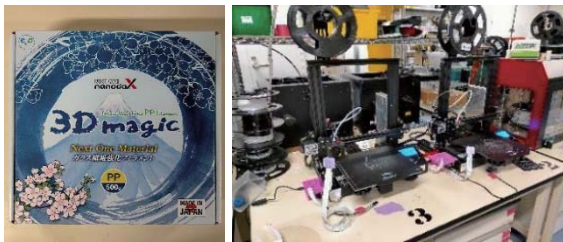
図 3 ナノダックス製 ガラス繊維強化 PP フィラメントと 3D プリント(Ender3-pro)
