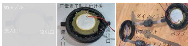
図 6. piezo 圧電素子にマイクロ流路制御とダイアフラムバルブを組み合わせたマイクロポンプ
