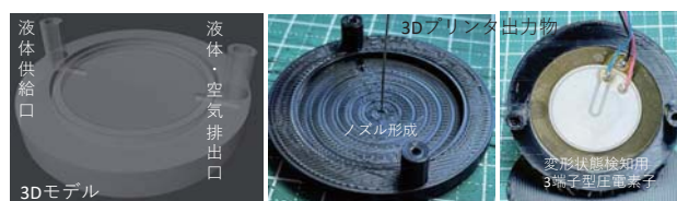
(c) 直径41φ素子利用の片面加圧・背面吐出形態
