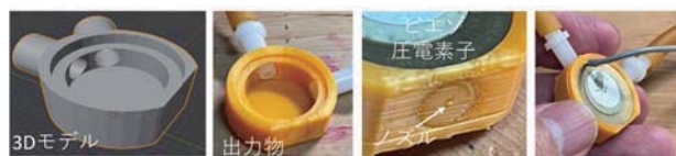
(a) 直径20φ素子を使った片面加圧・側面吐出形態
