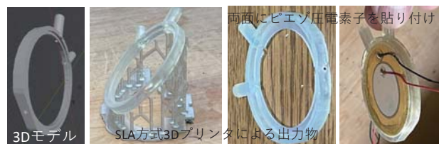
(b) 直径41φ素子利用の両面加圧・側面吐出形態
