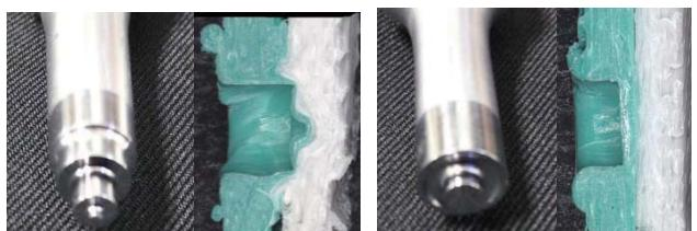
図 6. スポット型ホーンとフラット型ホーンと溶着断面
