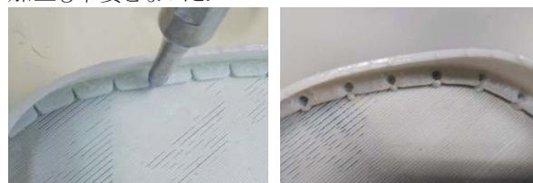
図 12. スリットの効果(溶着前と溶着後)
