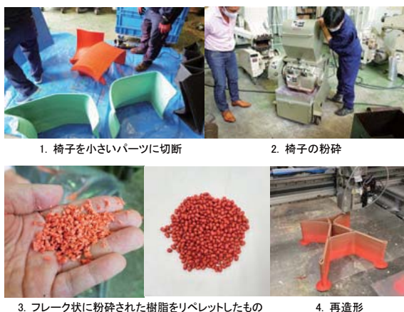
図8. 椅子の粉砕、リペレット、再プリントの工程
