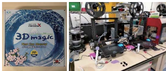
図 3 ナノダックス製 ガラス繊維強化 PP フィラメントと 3D プリンタ(Ender3-pro)
