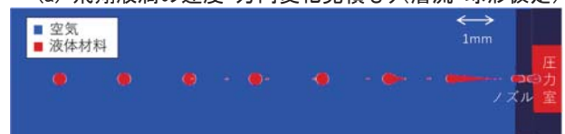
(b) OpenFOAM による飛翔吐出・速度見積り
