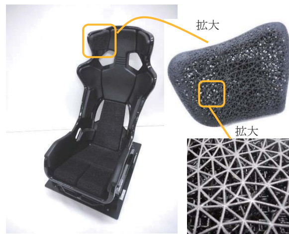
Fig.8 Kelvin14 面体を用いたレーシングシート (着座面全てのクッション材が 3D プリント造形品)
