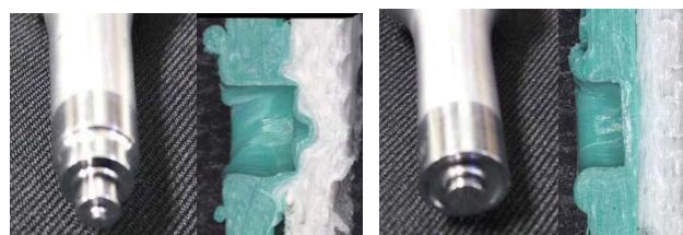
図 6. スポット型ホーンとフラット型ホーンと溶着断面
