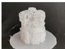
図 4. ウィア=フェラン構造の出力実験結果
