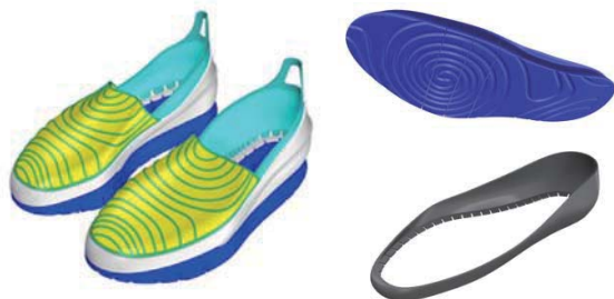
図 4. フットウェア 3D モデルと部品分解
