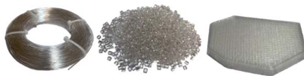
図 8. 株式会社 NEQAS 製 海洋生分解性プラスチックフィラメント(左), 同材料のペレット(中), 同材料を用いたプロトタイプ(右)
