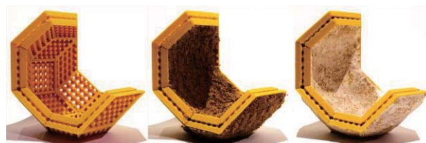
図9. 多孔質構造体に菌糸を詰めて成長させた様子
