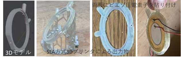
(b) 直径41φ素子利用の両面加圧・側面吐出形態
