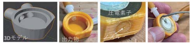
(a) 直径20φ素子を使った片面加圧・側面吐出形態
