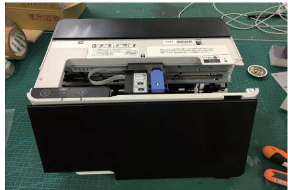
図 1. 蓋状のパネルまで取り外した状態
