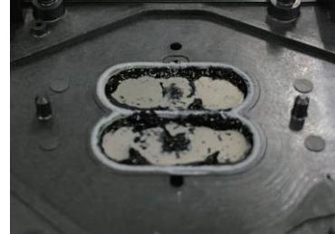
図 10. インク流路内の分解後の様子
