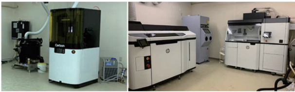
図 3. ラピセラが保有する 3D プリンタ (左: Carbon 社 L1, 右: HP 社 MJF5200)
