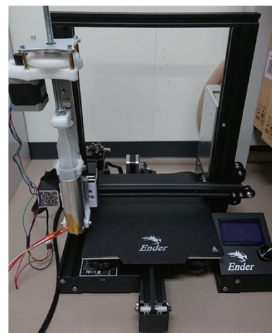
図 1. Ender3 にシリンジ型ノズルを取り付けた全体の写真
