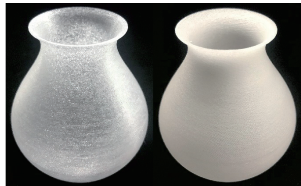
図 6. 振動によるテクスチャの有無の比較例
