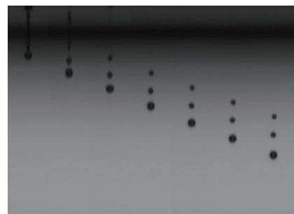
図 1. PBS 溶液の飛行状態(5μs 刻み)
