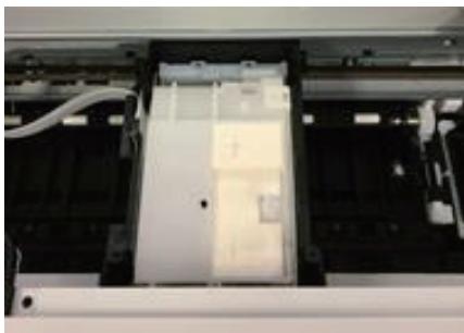
図 2. ヘッド上部のインクタンク
