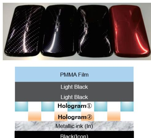
図 6. カーボンサンプル(上)、構成例(下)
