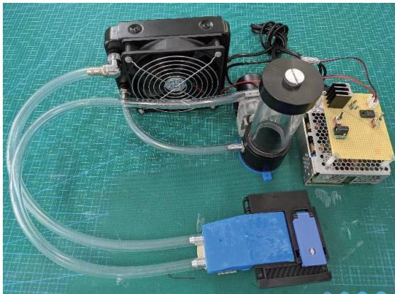
図 2. 水冷式冷却装置の構成
