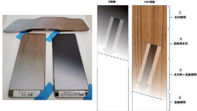
図 5. 木目-金属 Gradation(左)、Gradation イメージ(右)
