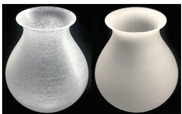
図 6. 振動によるテクスチャの有無の比較例
