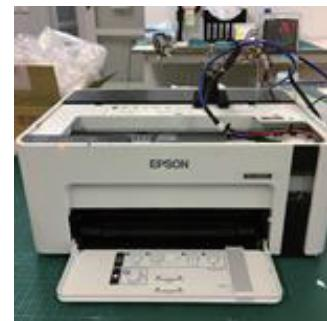
図 7. 筐体カバーを戻した改造機
