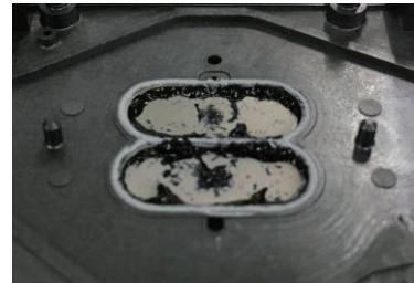
図 10. インク流路内の分解後の様子
