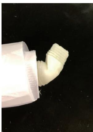
フレキシブルレジンを使用し作成した試作の蛇腹型関節は座屈することなく曲げることができた。また、フレキシブルレジンを使用した蛇腹型関節は人間の手で容易に曲げることが可能であった。しかし、この結果は本研究で必要としている高温時のみ曲がる構造とは異なり、蛇腹型のフレキシブルレジンは関節に不向きであるといった結果が得られた。また、強度的に問題があり複数回曲げを繰り返していると剥離現象が見られた。SMG で蛇腹型関節を造形したところフレキシブルレジンと比べ造形が失敗し、欠けている部分や造形されていない部分があった。しかし、蛇腹型関節の SMG はフレキシブルレジンと比べ硬く、常温時に人の手で変形することが不可能であった。以上の結果より、SMG は高温時のみ曲がることから関節の材料として適していることを確認することができた。また、蛇腹型構造は曲げに強く関節に適した構造だが SMG で造形する際には厚みを変えるなどの工夫が必要であることもわかった。
