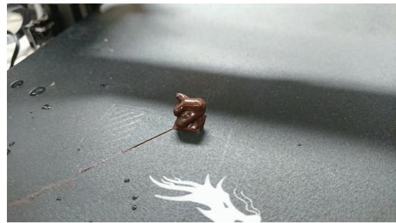
図 3. 10×10×10mm の立方体の造形結果
